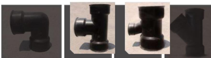
**Figura 22.** Piezas inyectadas: codos, tee wye, yee.
