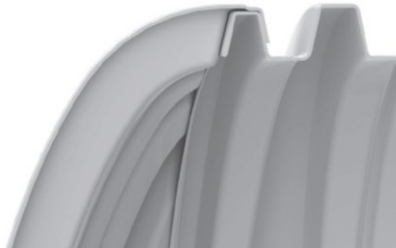
Figura 2. Colocación de las tapas
