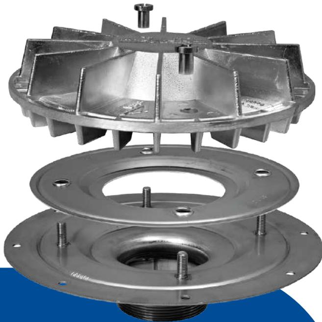
El drenaje pluvial sifónico es un sistema de captación acelerada para cubiertas, que opera con ayuda de la presión negativa. Las coladeras están especialmente diseñadas para evitar el ingreso de aire a la tubería, mientras el agua es conducida a tubo lleno usando el principio de sifón hidráulico.
